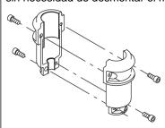
La bancada del motor conecta el cabezal de la bomba al motor. El cabezal de la bomba posee un tapón de cebado y un tornillo de purga de aire combinados de 1/2".
