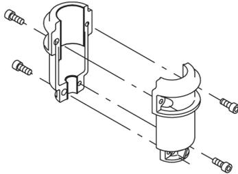
El cabezal de la bomba, la cubierta del cabezal de la bomba y la brida de montaje del motor están fabricados en una pieza. El cabezal de la bomba posee un tapón de cebado y un tornillo de purga de aire combinados de 1/2".
